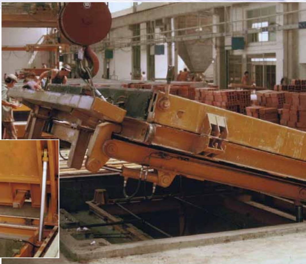
*Гидравлический наклонный стенд*
